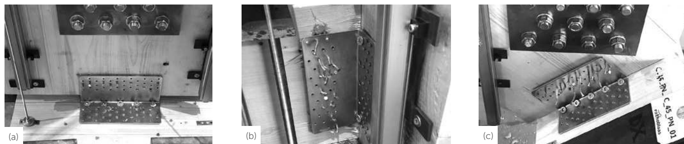
Figur 2. Prover exemplar i slutet av cykliska tester: dragbelastning (a), skjuvbelastning (b) och 45° (c) (delvis fastsättning).
