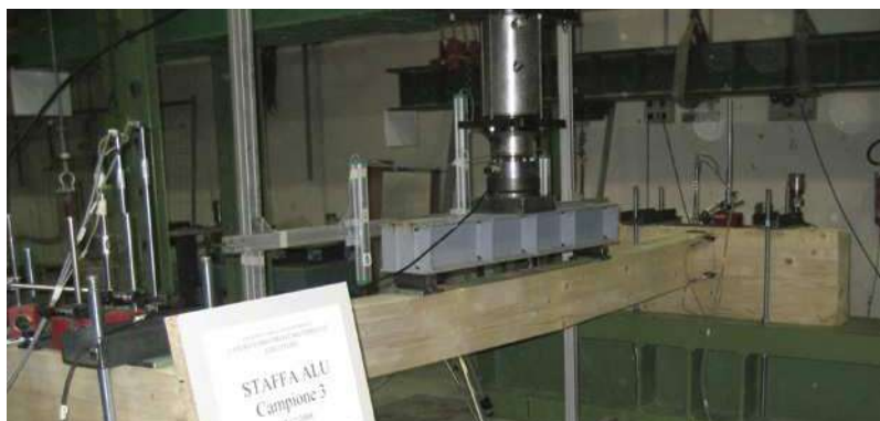
Test på fullskaliga provexemplar (anslutning primärbjälke/sekundärbjälke).
